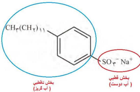
ب) شیاهت: همانند صابون دارای یک بخش قطبی و یک بخش ناقطبی است.
