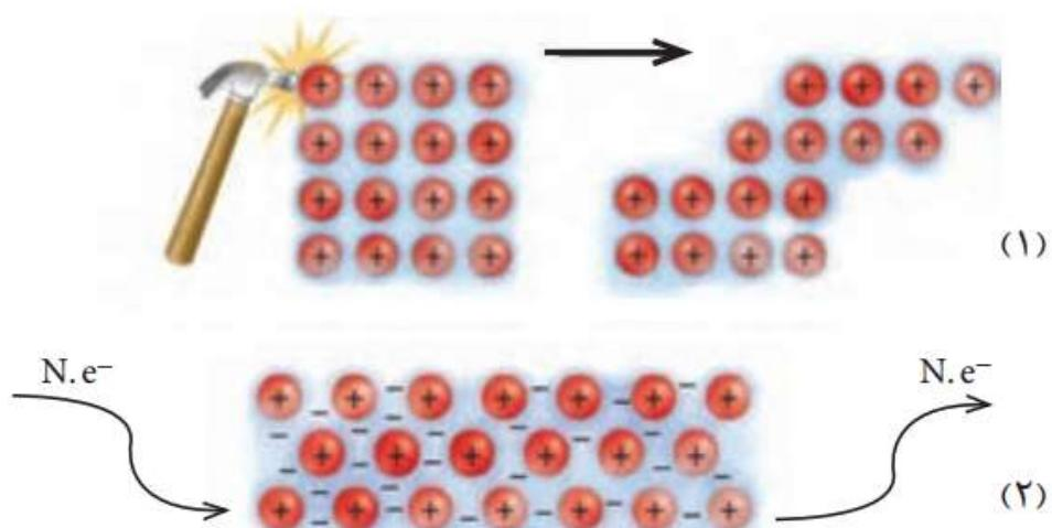
آ) هر یک از شکل ها نشان دهنده کدام رفتار فیزیکی فلز است؟ ۱: چکش خواری فلز (شکل پذیری)
